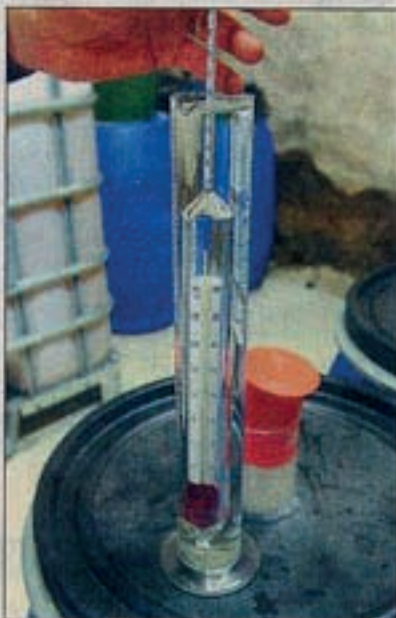
Die Spindel misst den Alkoholgehalt im Rohdestillat.
